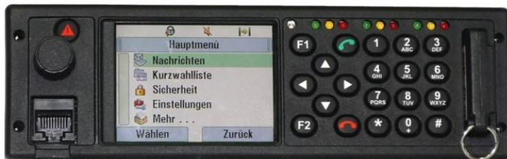
In jeder Variante ist der Steckplatz für den **SiKaPlug** integraler Bestandteil des Bediengeräts. Der **SiKaPlug** dient der Aufnahme der BSI-Sicherheitskarte und/oder als FMS-Kodierstecker.
